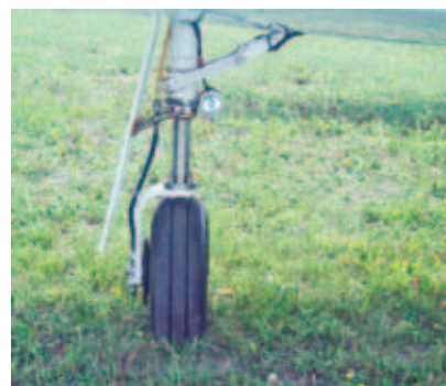
Колеса носовой и основных стоек одинаковые
