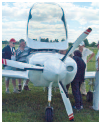
Воздушный винт MTV изменяемого шага с реверсом
